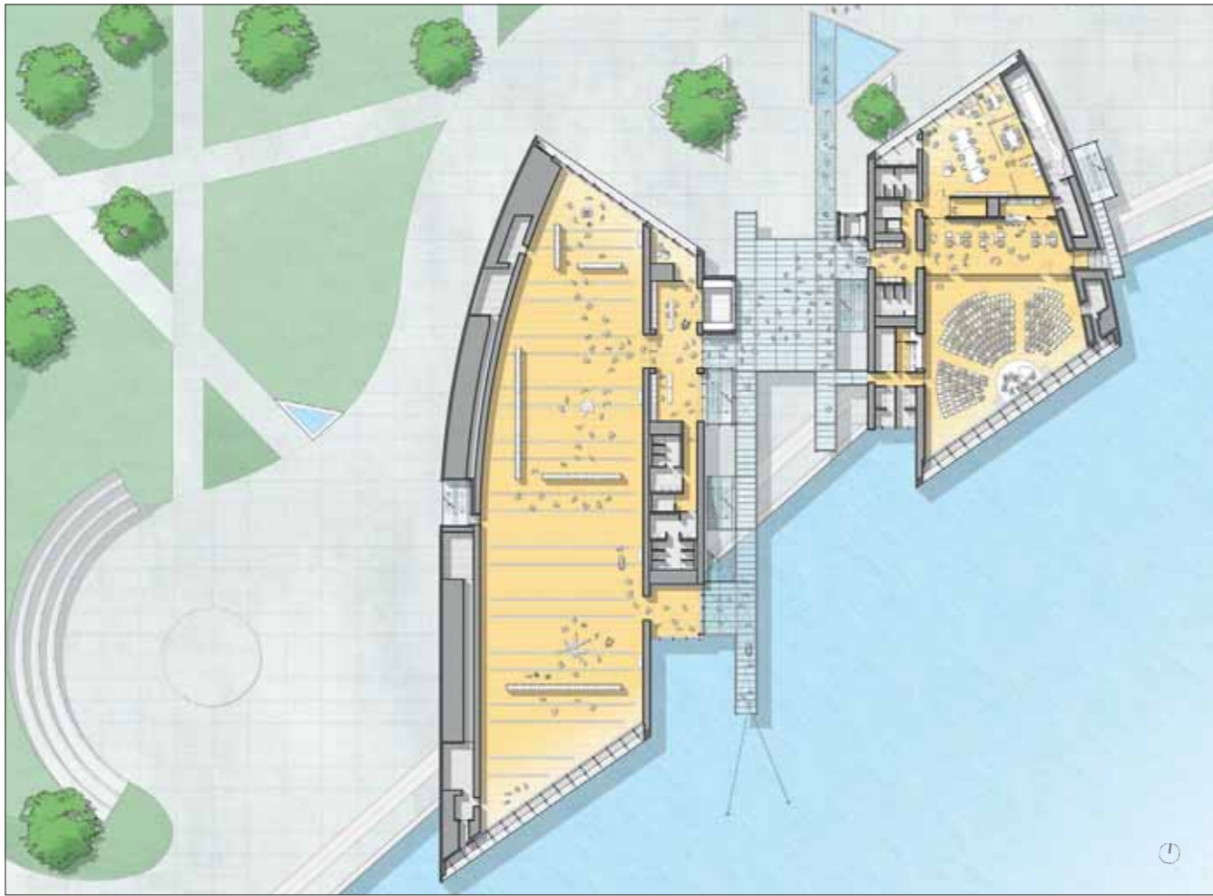
Das Centro Botín wurde in zwei Volumen geteilt: Das größere dient den Ausstellungen, das kleinere Veranstaltungen Grundriss und Schnitt im Maßstab 1:750
