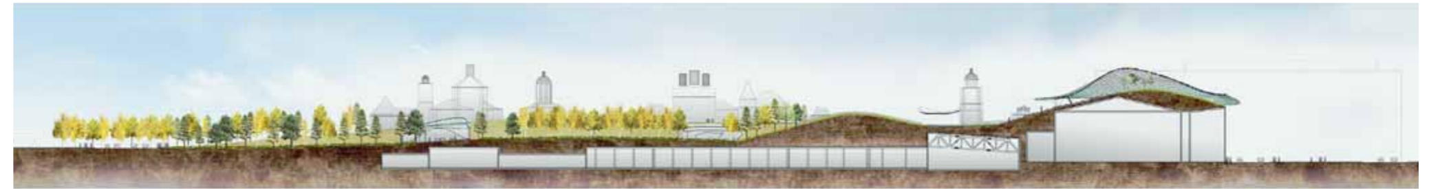
Die Klimahülle überspannt 9000 Quadratmeter und steht auf einem künstlichen Hügel, in den das Konzerthaus eingegraben ist. Schnitt im Maßstab 1:2000
