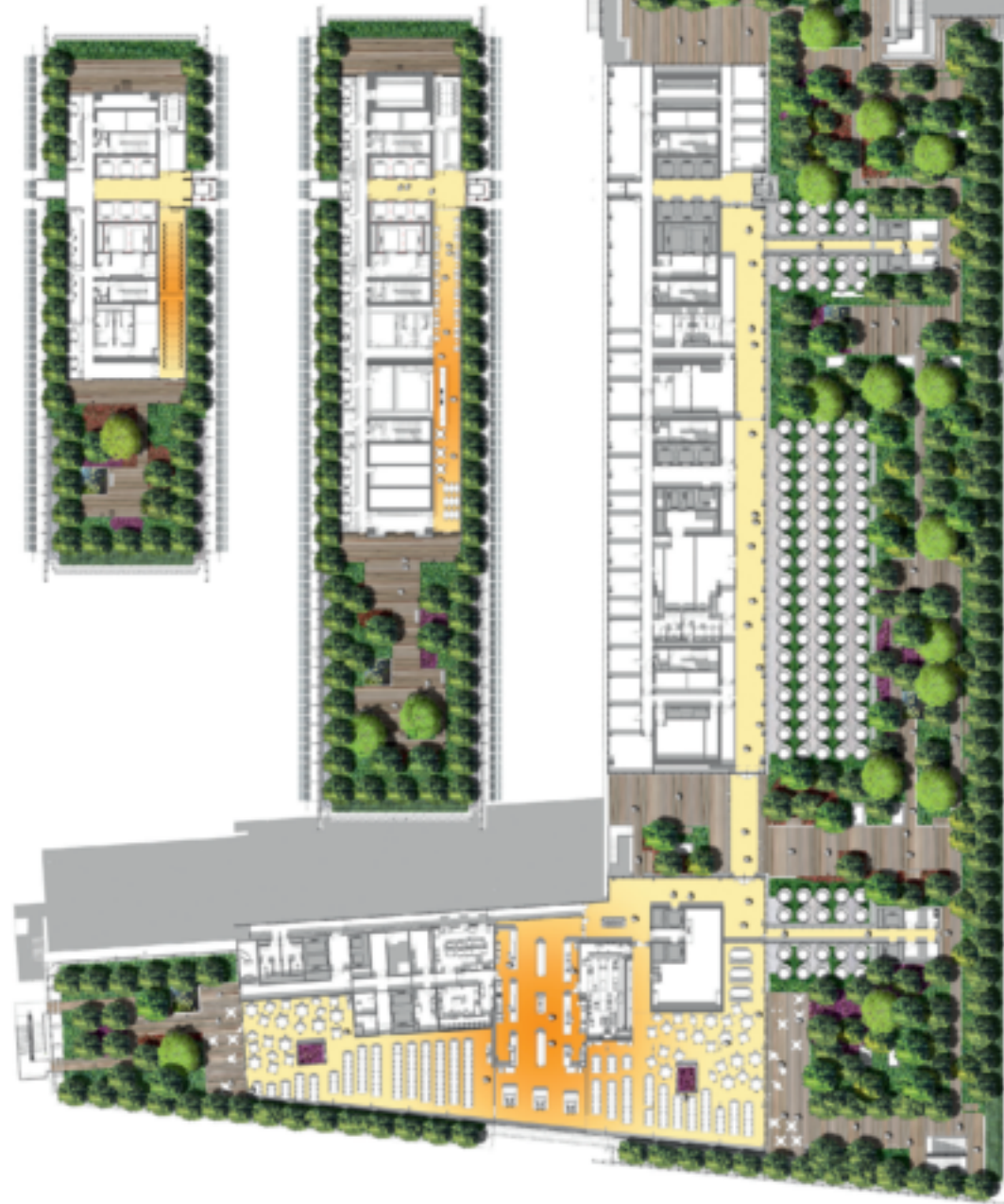
Der Turm wird durch drei begrünte Terrassen bzw. Umgänge untergliedert, die den Mitarbeitern zur Verfügung stehen. Im 8. Obergeschoss des Seitenflügels am Boulevard Berthier befindet sich das Restaurant. 8., 19. und 29. Obergeschoss im Maßstab 1:1000
