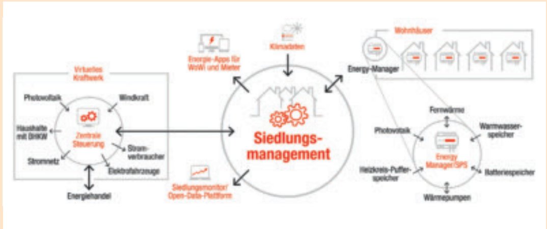
Aufbau des Managementsystems, mit dem sich der Stromverbrauch und die Wärmeerzeugung der Siedlung optimieren lässt Grafik: Rheinenergie, GrowSmarter Köln
