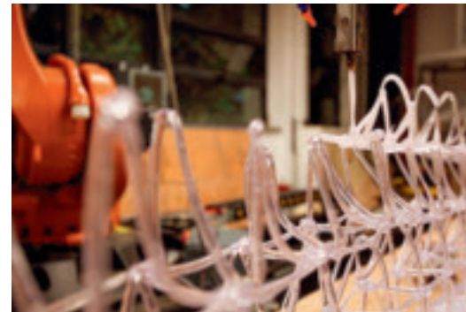
3D-Druck aus Recycling-kunststoff: Fertigung des „Cloud Village“ von Philip F. Yuan, der transparenten Struktur vor dem chinesischen Pavillon der diesjährigen Biennale in Venedig. © Philip F. Yuan
