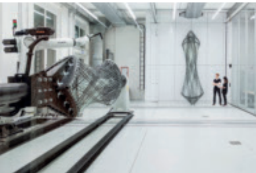
Die Institute ICD und ITKE der Uni Stuttgart entwickelten zwei bionisch inspirierte Pavillons für die Bundesgartenschau Heilbronn 2019. Der „Bionische Faserpavillon“ baut auf der jahrelangen Forschung der Institute zu tragenden Faserverbundstrukturen auf. Die Konstruktionselemente aus Carbon- und Glasfasern werden robotisch in einem kernlosen Faserwickelverfahren hergestellt. (Siehe auch Seite 40).
