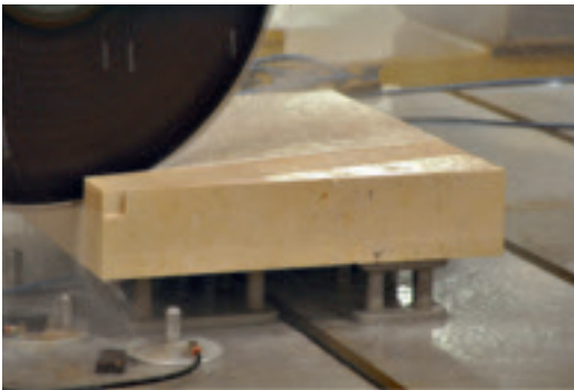
Eine Gewölbeschale aus 399 Kalksteinblöcken, die ohne mechanische Verbindung oder Mörtel verbaut wurden. Was ausgesprochen analog daher kommt, ist aber nur mithilfe hochpräziser, digitaler Berechnungs- und Vorfertigungsprozesse möglich. „Armadillo Vault“ der Block Research Group, ETH Zürich, auf der Architekturbiennale Venedig 2016 Fotos: Anna Maragkoudaki (oben); David Escobedo
