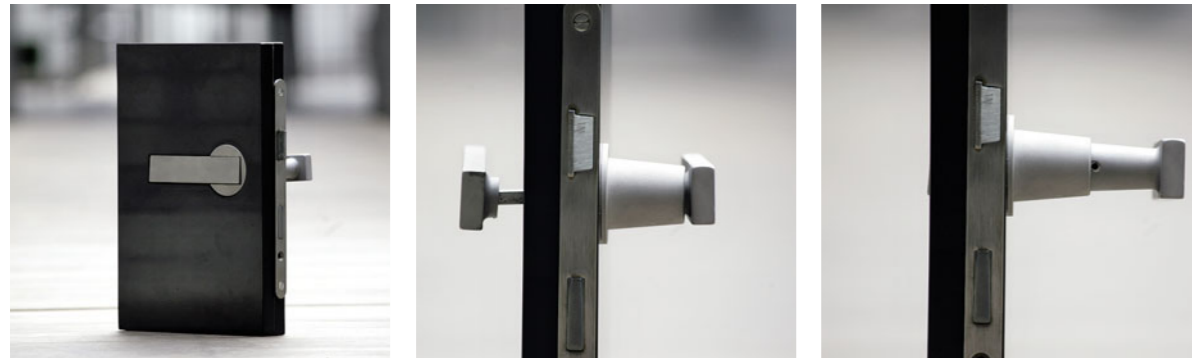
Flat. Die versenkbare Klinke | Bei seiner Klinke entwickelte Raoul Gross Modelle von flächenbündigen Rosetten in der FSB-Serie weiter. Sie ist versenkbar und schließt neben der Rosette flächenbündig mit der Tür ab. Das hat nicht nur ästhetische, sondern auch funktionale Gründe. Im WC müsste man so kein Schloss mehr betätigen, sondern kann die Tür durch Heranziehen der Klinke von innen verschließen.
