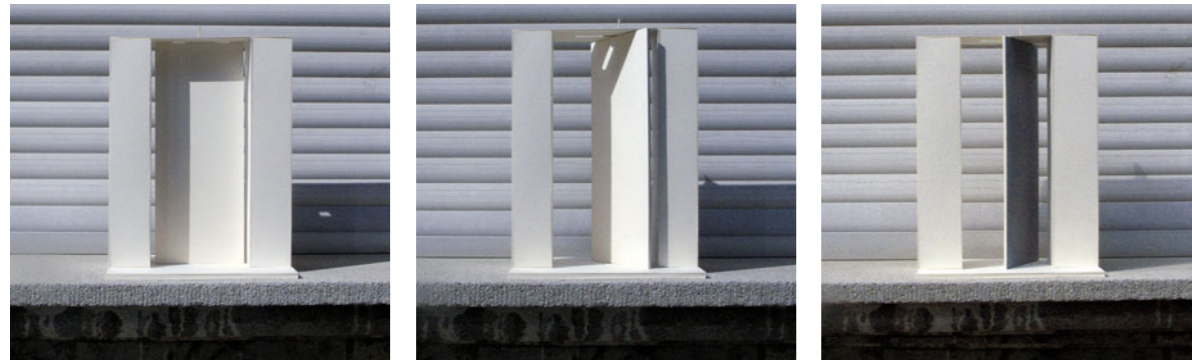
360° Door | Eine Tür, deren Türblatt sich wie bei einer Drehtür herumdreht, hat Timo Luitz vorgeschlagen. Dabei wird die Drehachse von der Mitte der Tür zur Zarge und wieder zurück bewegt. Man kann die Tür nach Belieben entweder auf der rechten oder linken Seite drücken oder ziehen. Da sie sich mit der hindurchgehenden Person mitdreht, muss man nicht umgreifen. Das Öffnen, Hindurchgehen und Schließen wird zu einer flüssigen Bewegung. Alle Abbildungen: Verfasser
