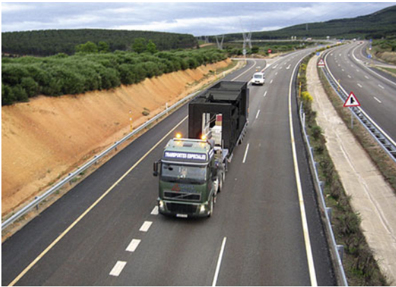
Die Module wurden von der Fabrik bei Madrid in das 700 Kilometer entfernte Cedeira gefahren. Der logistische Aufwand war groß, dafür entfiel die örtliche Präsenz von Handwerkern und Architekten.
