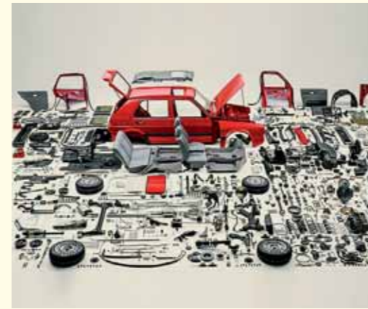
Upcycling: Das Gebäude wird wie ein Auto in sortenreine Materialien zerlegt, die alle ohne Qualitätsverlust recycelt werden Fotos: Volkswagen AG (oben); Arnold Newmann
