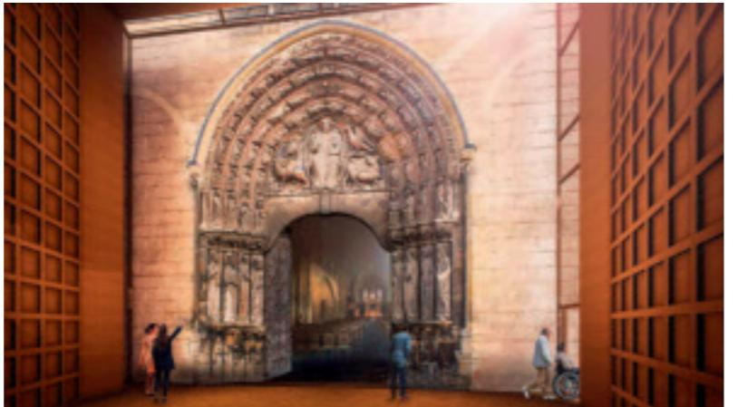
**Teilnehmer** Rudy Ricciotti konstruiert einen Tunnel mit fünf ineinander greifenden Modulen aus Faserbeton. Die Bögen sind so geformt, dass sie Regenwasser ableiten und über einen Dichtstreifen mit der Fassade verbunden sind.
