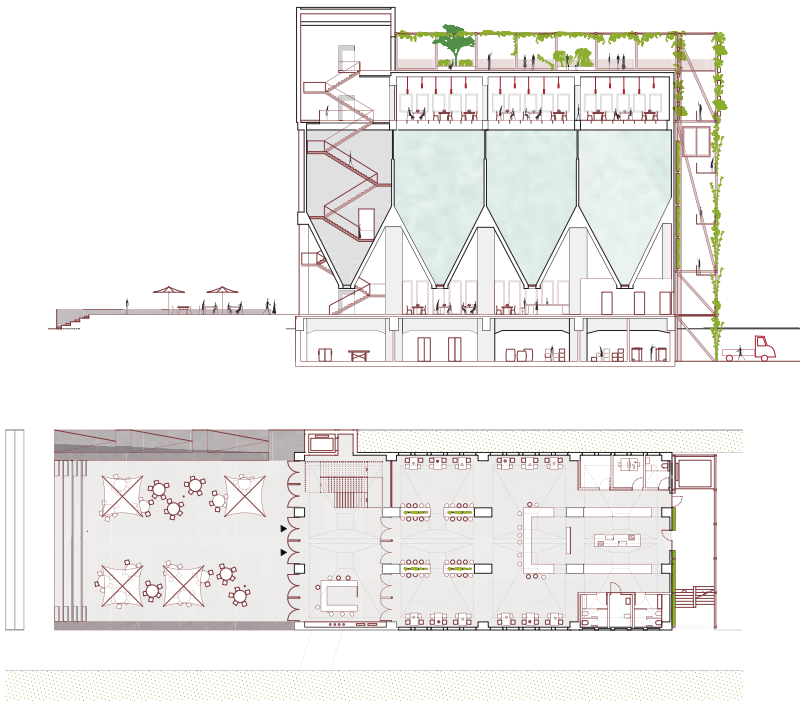
1.Preis Gernot Schulz Architektur betont mit den rohen Kohletrichtern den industriellen Gebäudecharakter. Illuminiert und mit Glasböden ausgestattet, sollen sie spannungsvolle Reflexionen auf den Boden des Erdgeschosses transportieren. Alle Abbildungen: Verfasser, Grundriss und Schnitte im Maßstab 1:750
