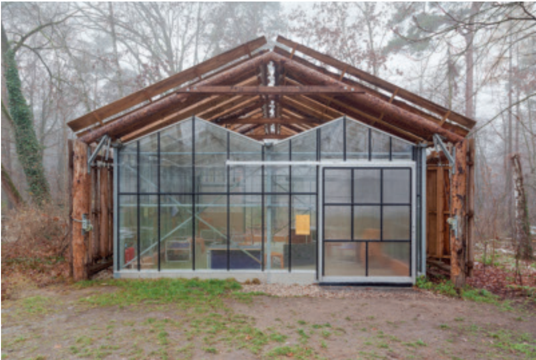
Blick auf den gartenseitigen Zugang Rechte Seite: Die geschlossenen Lamellen aus Schwartenholz verhindern bei Sonneneinstrahlung ein zu starkes Aufheizen des Gewächshauses. Großes Foto: Constanze Flamme; Querschnitt und Grundriss im Maßstab 1:200
