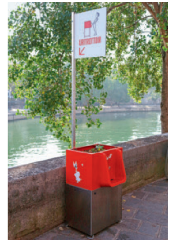
Neues „Uritrottoir“ in Paris: Bei den Freiluft-Urinalen mit Blumenkasten pinkelt der Nutzer in einen Behälter mit Stroh. Der Inhalt wird zu Kompost und als Dünger von Grünanlagen verwertet. Foto: alamy
