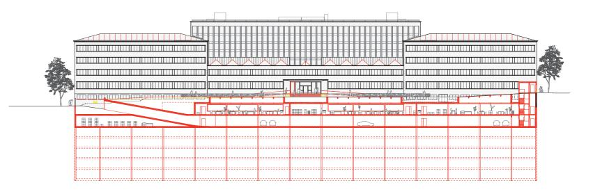
Der unterirdische Erweiterungsbau beinhaltet Ateliers, Tiefmagazin und Parkplätze. Das Entfernen der Treppe im Bücherturm erzeugt verspringende Aussparungen in Boden und Decke, die das starre Tragsystem auflockern.
