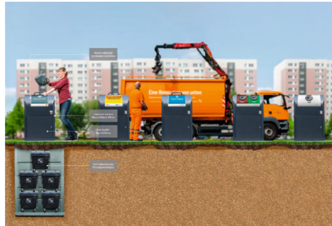
Das Unterflursystem: Die benötigte Fläche für den Müllplatz reduziert sich um bis zu zwei Drittel im Vergleich zu herkömmlichen Tonnen. Abbildungen: BSR
