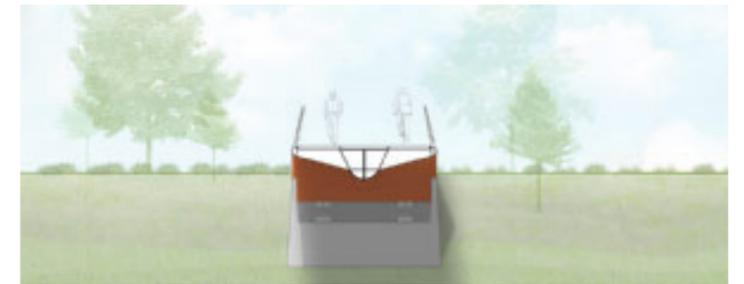
Bis zu einer Länge von 45 Metern kann die Geh- und Radwegbrücke G-2 als Fertigteil hergestellt werden. Die Stahlkonstruktion kann also schnell in Betrieb gehen, der Eingriff in Uferbereiche und Wasserzonen während der Bauzeit verringert sich. Die Laufplatte besteht aus einem Lochblechrost, damit Wasser ablaufen kann, in das Gelände ist ein Netz eingespannt.
