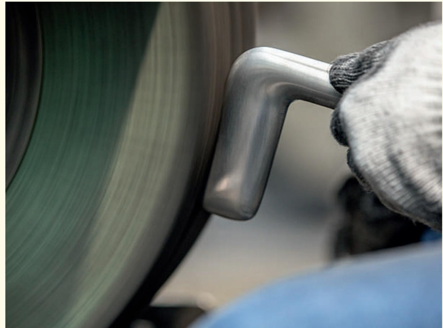
Nach dem Auskühlen wird die Güte des Gusses kontrolliert, der Anguss entfernt und der Wiederverwertung zugeführt, der Rohling händisch geschliffen und zur Oberflächenveredlung weitergereicht. In Trowaliertrömmeln entsteht die angestrebte Akkuratess: Radien und Kanten werden mittels kleiner Keramikkegel behutsam bearbeitet. Abschließend wird die Oberfläche poliert, gestrahlt und bei farbigen Modellen eloxiert oder pulverbeschichtet – oder eben so belassen.
