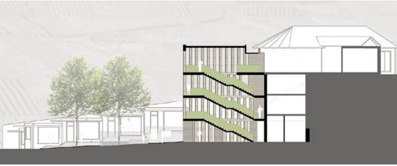
2. Preis | Architektin Sandra Schlotter will durch einen geneigten Platz und durch Aufzüge neben einläufigen Treppen den Zugang zur Bahn frei von Barrieren gestalten
